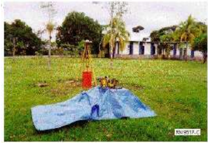
Figura 35 - Estação 9517C (Prisma quadrangular de concreto, medindo 30cm de lado e altura de 50cm, com chapa de metal cravado no topo, estampada).
