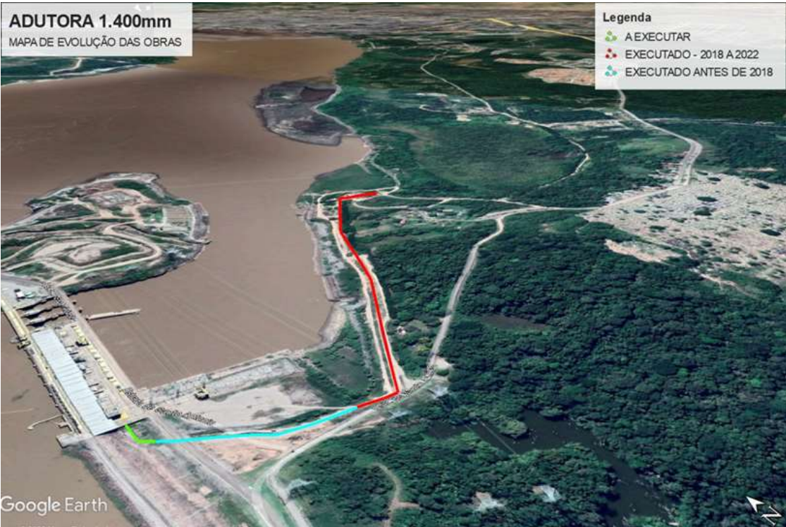
Figura 70 -Vista do caminhamento da adutora de DN 1.400 mm, na margem direita do Rio Madeira. Trecho inicial ainda sem tubulação.do Rio Madeira. Trecho inicial ainda sem tubulação, junho/2022
