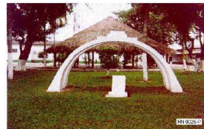
Figura 33 - Estação 9025P (Prisma quadrangular de concreto, medindo 30cm de lado e altura de 50cm, com chapa de metal cravado no topo, estampada).
